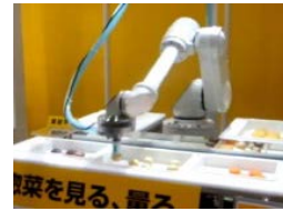
食品を詰替えるなど、繰り返し単純作業を自動で行うロボット
