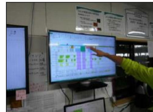
○システムの画面(出典：農水) 飽差を意識し、天窗・ミス等を連動させて環境制御を実施
