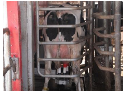
乳房の自動洗浄、ミルク自動装着
