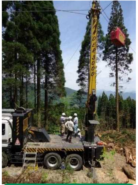
日本の森林に合った高性能林業機械の導入（タワーヤード）
