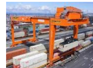
RMG(レール式トランスファークレーン)
