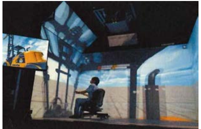
【VRを用いた重機のシミュレータ】
